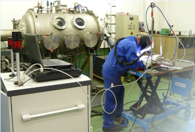
Entwicklung und Erprobung von neuen Schweißarbeitsplätzen in der ASE Apparatebau GmbH, Chemnitz Abb. rechts: Datenerfassung und Dokumentation beim Schweißen von Zirkonium bzw. Zirkoniumverbindungen
